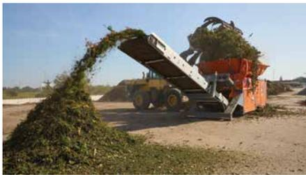
**Mit unseren Trommelsieben** lässt sich auch Ihr Schüttgut, genau in verschiedene Korngrößen aufteilen. Bei größeren Mengen (ab 250m<sup>3</sup>) können wir **direkt bei Ihnen vor Ort in Ihrem Betrieb sieben**. Besonders effektiv funktioniert die Trommelsiebtechnik bei **Erde, Kompost und geschredderten Grünschnitt**.
